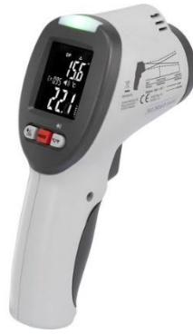
Abb. 4.3: Das Infrarotthermometer wird direkt auf eine Oberfläche gehalten und misst, mit welcher Temperatur diese Fläche abstrahlt. Menschen nehmen unbewusst die sie umgebenden Oberflächentemperaturen wahr. Sie sind Teil des Hitzeempfindens der Menschen.
