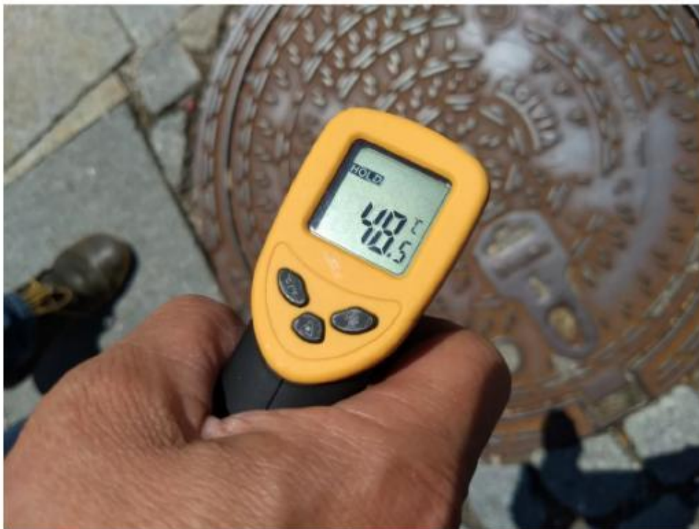
Abb. 4.4: Beispiel für eine Messung der Oberflächentemperatur mit einem Infrarotthermometer: 48.5 °C bei 28 °C Lufttemperatur.
