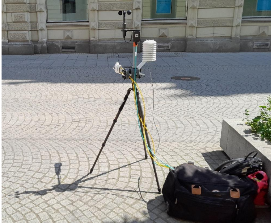
Abb. 4.1: Mobile Messeinheit EMMA ( E nvironmental M obile M easurement of A mbient Comfort) zur Erfassung der von Menschen gefühlten Temperatur. Dabei werden Lufttemperatur und Luftfeuchtigkeit (weißer Zylinder), Windgeschwindigkeit (Windrad) und Strahlung (weißes Gerät hinten auf dem Stativ) gemessen.
