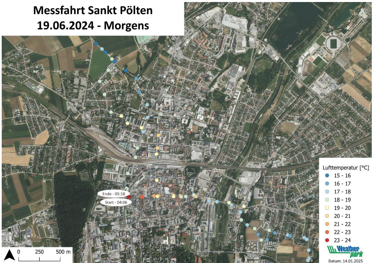
Abb. 4.16: Ergebnisse der Messfahrt in St.Pölten vom 19.06.2024 (morgens) in °C. Die farbig ausgefüllten Kreise korrespondieren mit den Temperaturklassen in der Legende an den jeweiligen Messstandorten entlang der Messfahrtroute.
