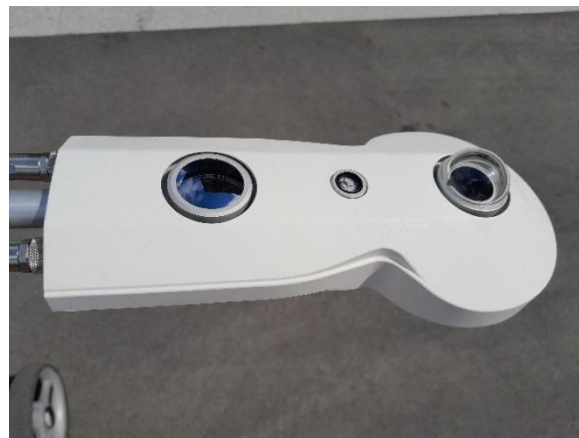
Abb. 4.2: Detailansicht des Strahlungsmessgeräts. Das Net-Radiometer misst Sonnenstrahlung (direkt von der Sonne und diffus, also reflektiert und gestreut) und Wärmestrahlung (Infrarot). Durch Drehen und Umpositionieren des Messgeräts werden diese Parameter in allen 6 Raumrichtungen gemessen.
