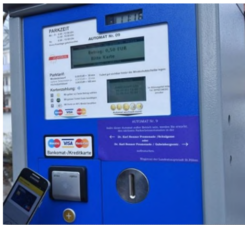
Abbildung 5: Parkscheinautomat mit NFC-Technologie
